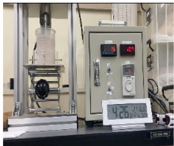
図1：本実験で用いたペーン式せん断試験機
