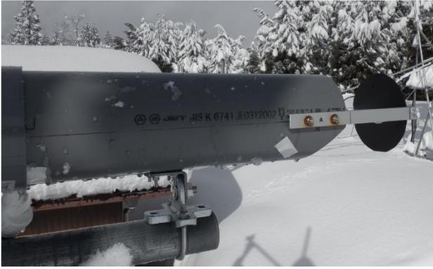
図 1 試作した降水量計。
