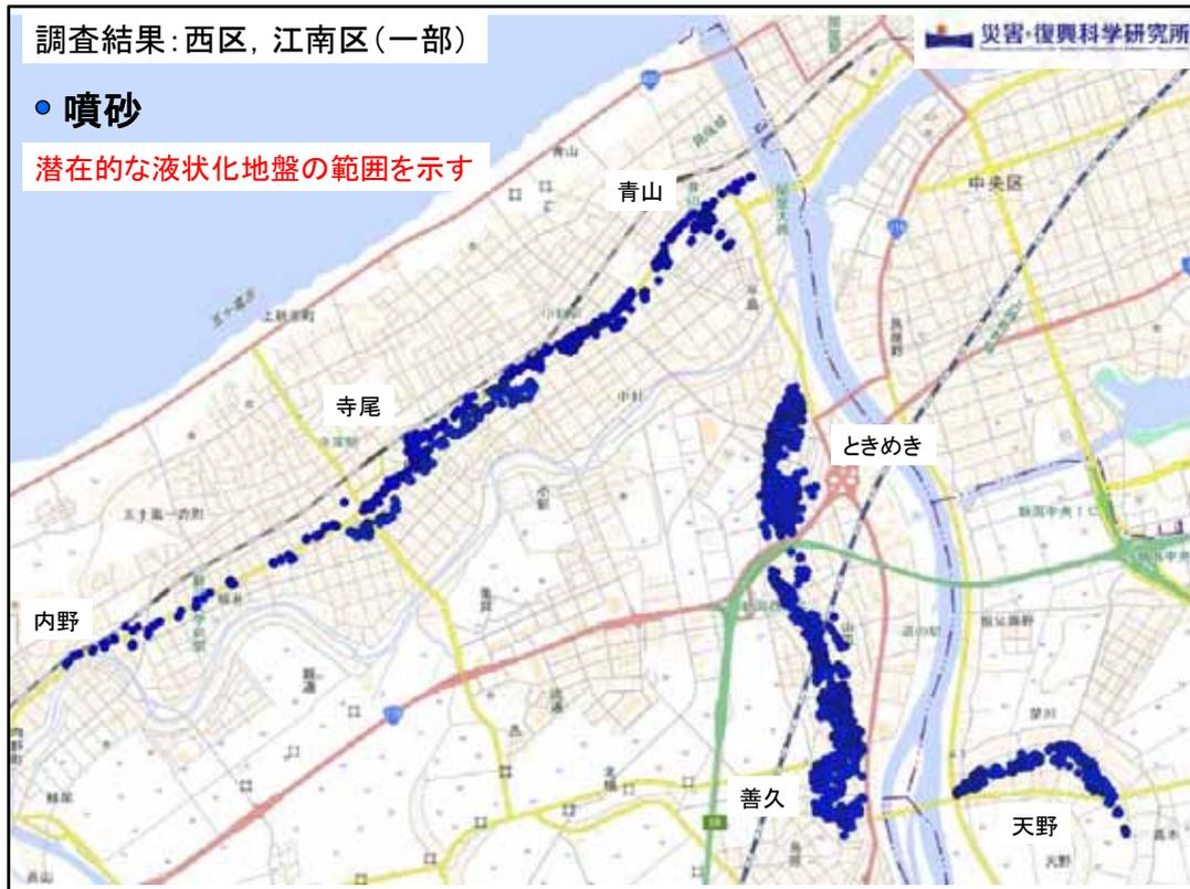
2024年1月に実施した被害調査では、新潟市西区の青山～内野地区、ときめき～善久地区、江南区の天野地区において、噴砂、道路の変形、道路や敷地での亀裂、建物の傾きや沈下、宅地擁壁の損傷、湧水などを記録しています。図中の青丸は、現地調査時点で確認できた噴砂(砂が噴出している亀裂や穴など)の位置をしめしています。
