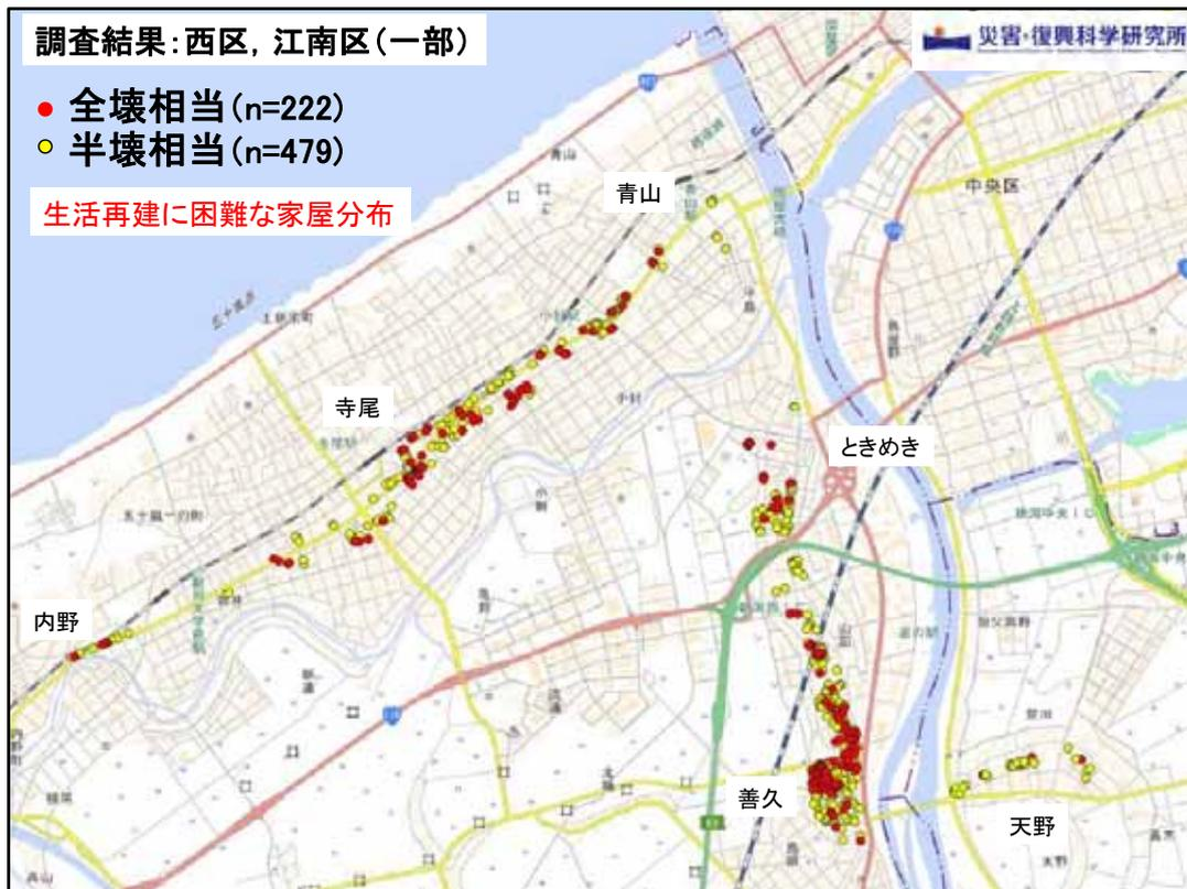
この図は、調査時に外見の観察から判断した建物被害の程度を示しています。全壊相当としている建物は、直接的に計測していませんが、垂直1mに対して5cm以上傾いている建物や30cm以上沈下している建物、亀裂により大きな損壊を受けている建物などを示しています。また、半壊相当としている建物は、外見から明らかに傾いている建物、沈下している建物などを記録しています。外見のみの判断なので、行政が実施した罹災証明のための建物調査と判定が異なりますが、大学の調査は被害全体の様子を把握するための初動調査として実施しており、生活再建が困難な建物数の概要と分布を求めたものです。災害の初動調査では、どの場所に大きな被害が分布しているのか、集中しているのかの把握が重要であり、この把握によって復旧の全体像や規模を探ることができます。
