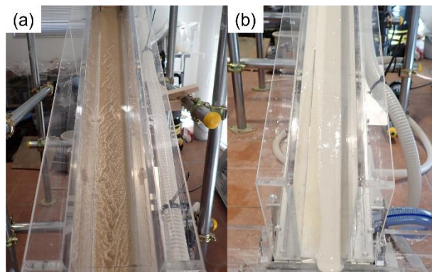
図 8 (a)珪砂と水の混合物、(b)珪砂とカオリンと水の混合物をそれぞれ流下させた水路流下実験後の水路。
