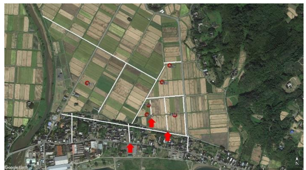
Fig. 3 GPR 調査測線 (白の実線).
