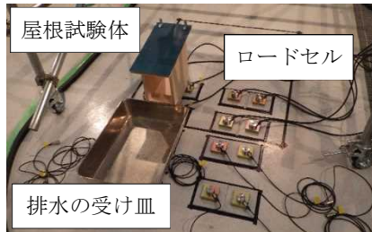
写真4 ロードセルの設置状況
