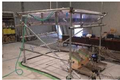
写真2 降雨装置 (外観)
