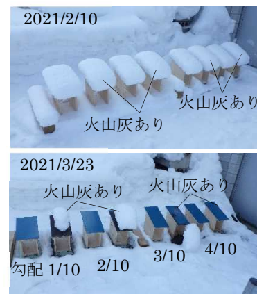
写真7 屋根試験体の状況
