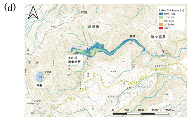
図5 各熱水変質帯を発生源とした泥流の流下範囲の数値計算結果。(a)傾城岩変質帯起源、(b)大黒天変質帯起源、(c)五色沢西変質帯起源、(d)丸山沢西噴気地帯起源。
