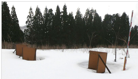
Fig. 3) 栃尾田代に設置した西向き (左)・東向き CR (右) (2020年2月23日 14:20)。東向き CR の底面にはわずかしき積雪がないことがわかる。
