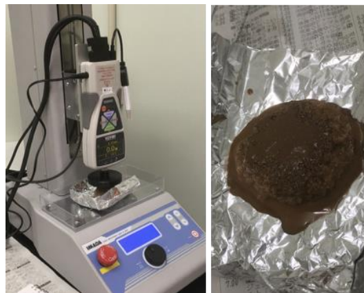
図 2：凝集体の圧縮実験の様子（左）と圧縮された後の凝集体の様子。
