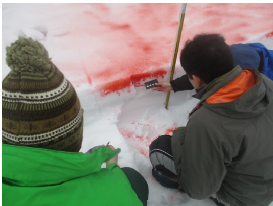
図4. 新潟県魚沼市大白川で行われた野外実験 雪面にエオシンを散布した場合。
