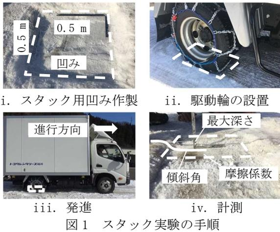
の2トンアルミトラックを用いた。その車体重量は2630 kg（後輪重量は1140 kg）、後輪はダブルタイヤであり、前後輪ともにスタッドレスタイヤ（195/75R15S）である。試験条件として、輪荷重は570 kg、820 kgおよび1070 kg、窪みの深さは0~100 mmの範囲、チェーン装着の有無、とした。タイヤチェーンは輪荷重との適合により金属製を採用した。なお、試験では、外気温、圧雪の密度および質量含水率を測定した。圧雪層の厚さは0.5 m程度であり、試験時にタイヤが舗装に接触することはない。輪荷重は、トラックの荷台に大型タンクを2個載せ、その中の水容量によって変化させた。
