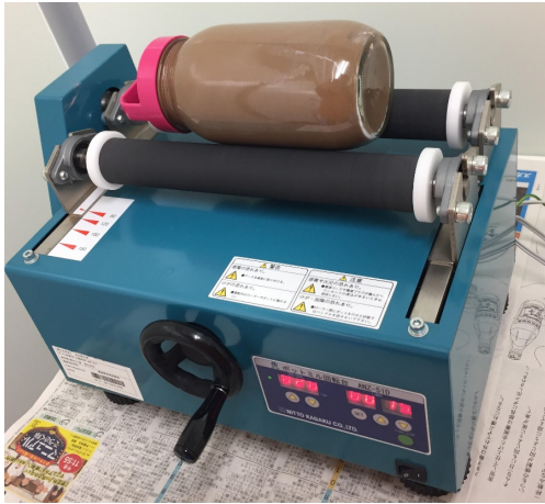
図1：ポットミル回転台による泥流中での凝集体形成実験系。
