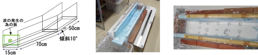
図4. 流路実験の装置
