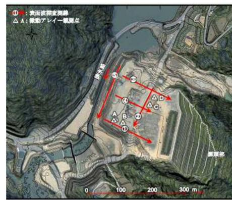
図1 東竹沢地すべりの平面図、物理探査測線、および微動アレイ観測点
