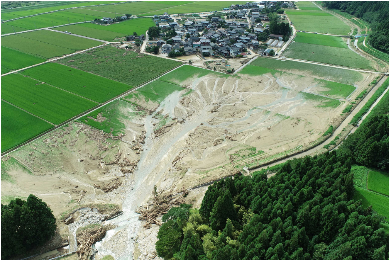
ドローン写真2 2022/8/8 (撮影方向：西北西) 川部地区東方の赤坂川で発生した土石流出の状況
