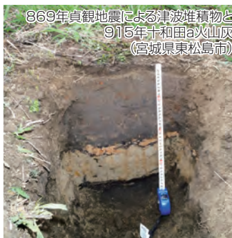
ハンディージオスライサーによる 津波堆積物の調査 (宮城県東松島市)
