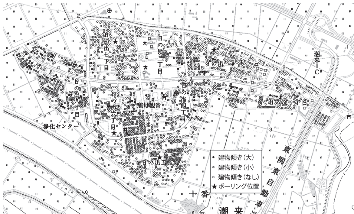
図1 潮来市日ノ出地区での液状化被害
