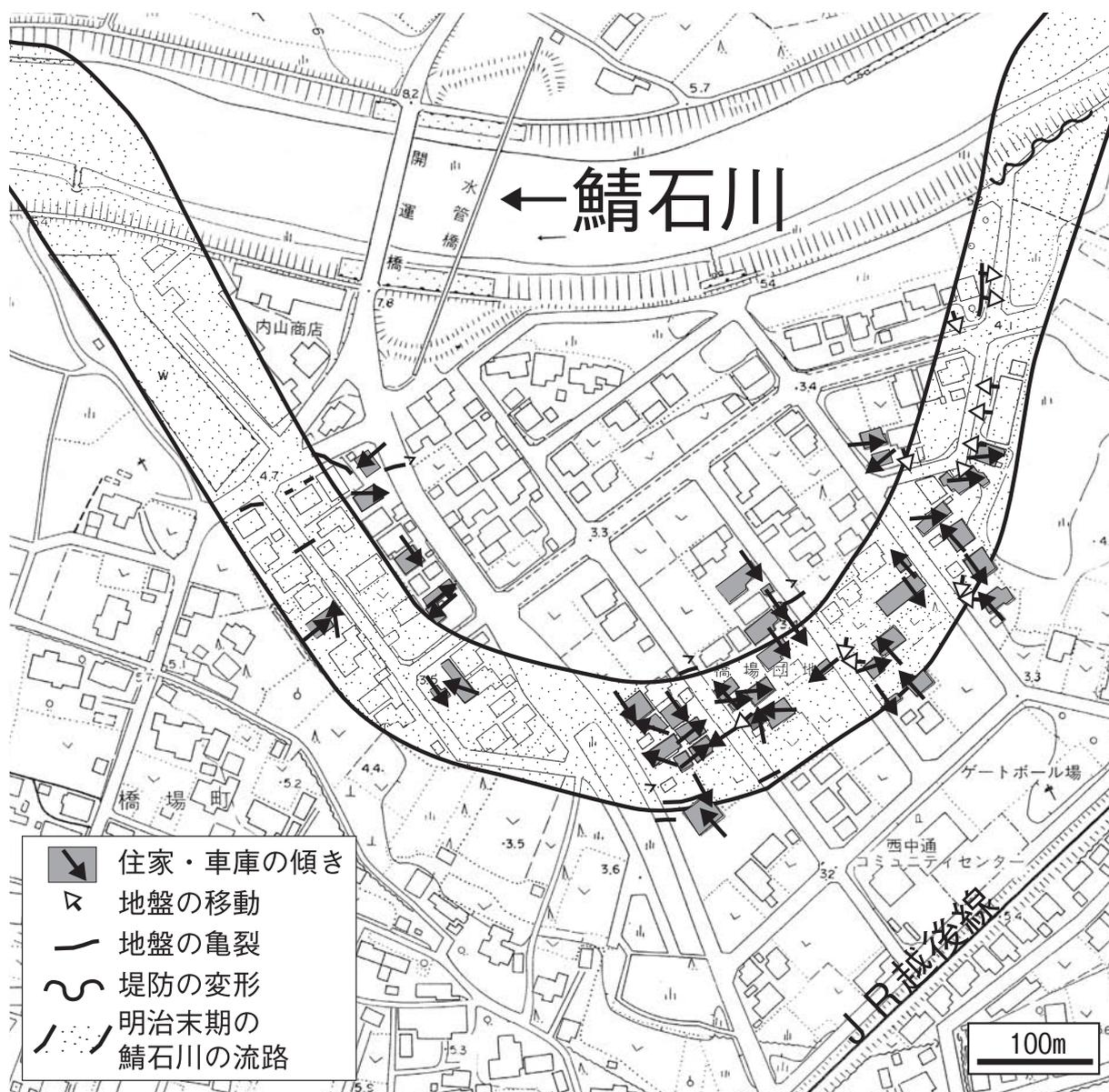
図-8 柏崎市橋場地区の旧鯖石川流路と液状化による構造物の不等沈下。柏崎市発行1/10000地形図の一部を使用
