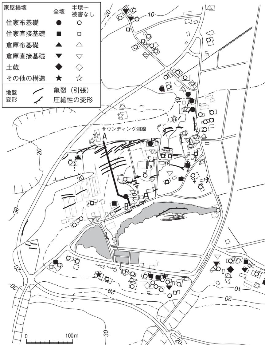
図-14 柏崎市長崎地区の砂丘斜面末端部での被害分布
