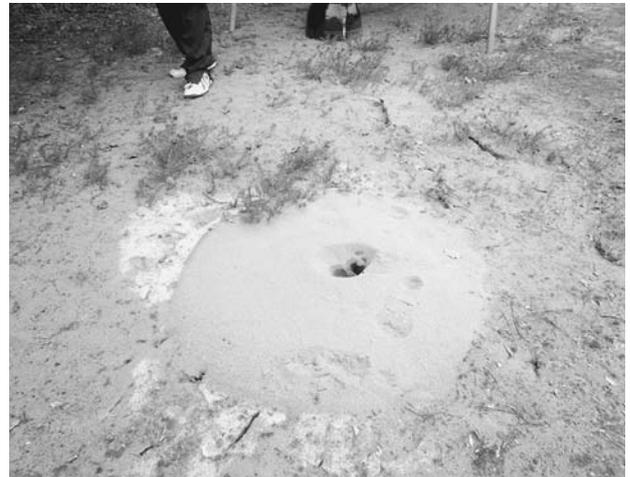
写真－3 地すべりを起こした宅地に見られる亀裂と液状化
